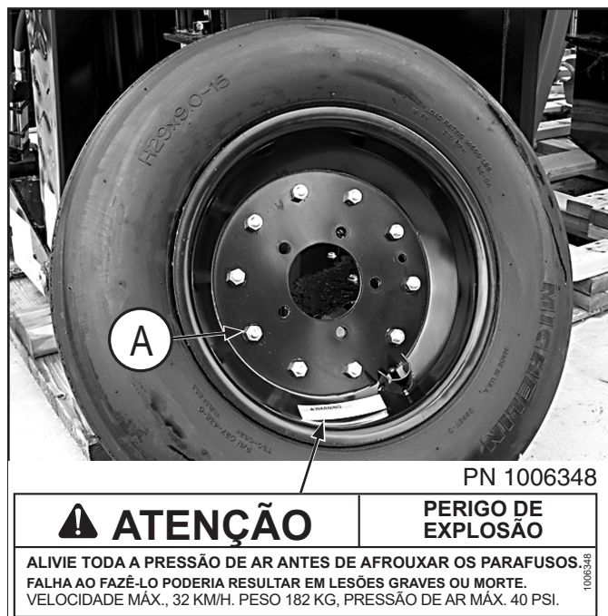
Figura 9. Manutenção do Pneu de Aro Dividido
