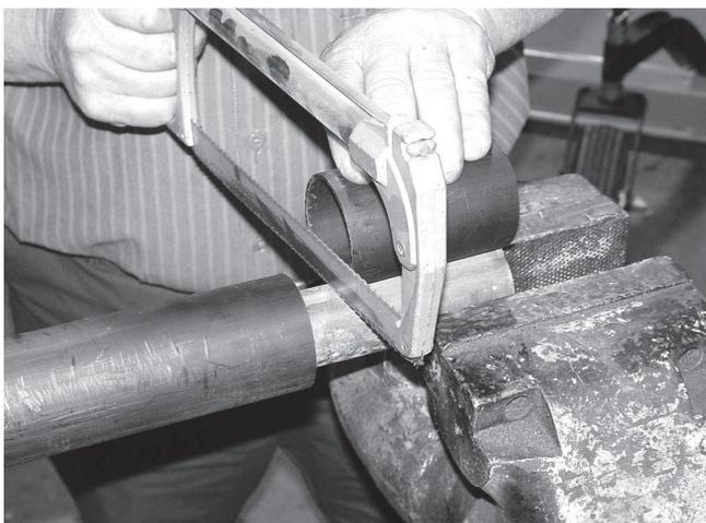
**Figura 6.** Corte do Eixo
