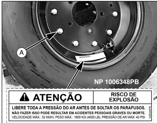
Figura 8. Manutenção de pneu com aro bipartido
