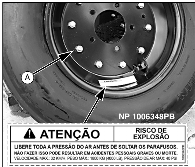
Figura 20. Manutenção de pneu com aro bipartido
