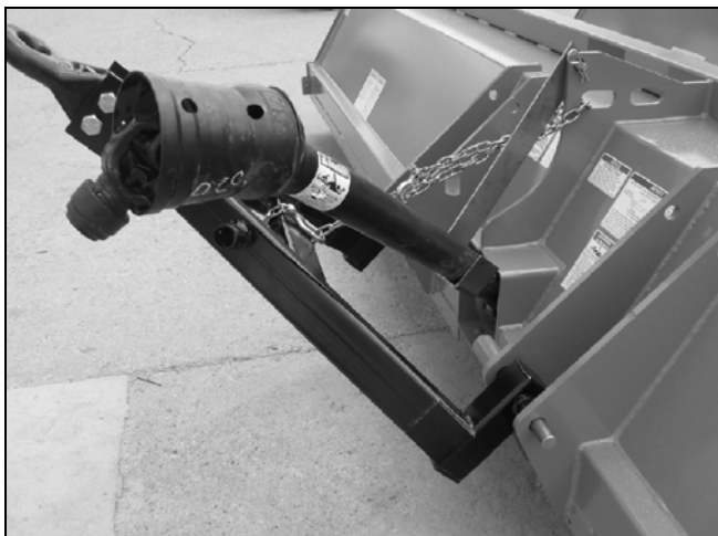
Figura 24. Barra de tração e TDP na posição de transporte
