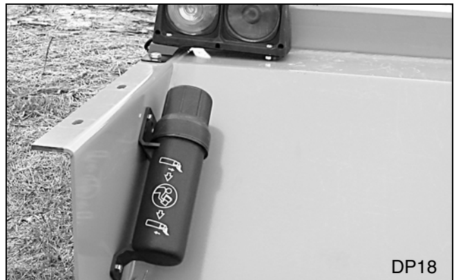
Figura 53. Tubo manual instalado
