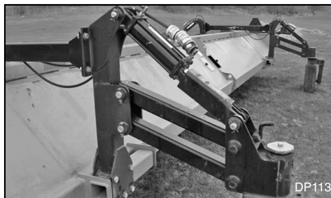
Figura 32. Pontos da lubrificação do tubo do pivô
