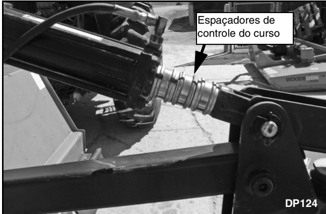
Figura 10. Ajuste da altura operacional
