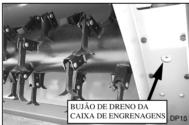
Figura 35. Bujão de dreno (lado de baixo da unidade)
