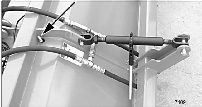
**Figura 24.** Local de enchimento de óleo da caixa de engrenagens
