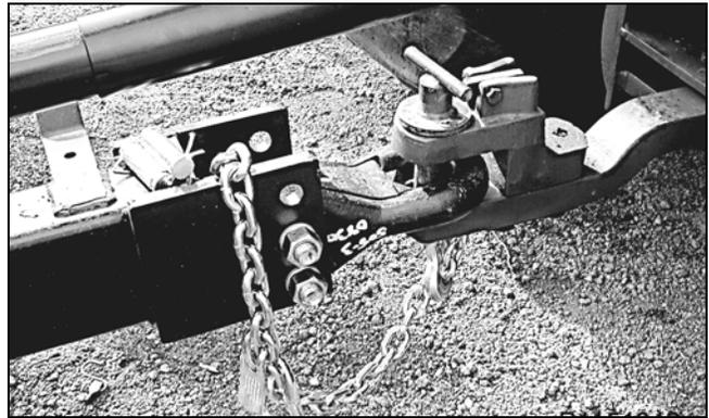
Figura 8. Barra de tração e corrente de segurança
