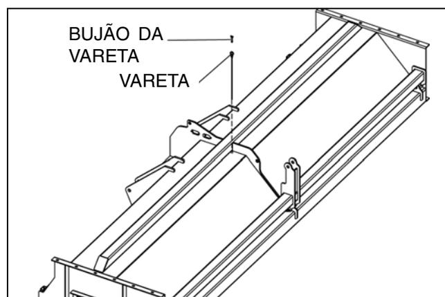
Figura 40. Remoção do bujão de transporte da vareta
