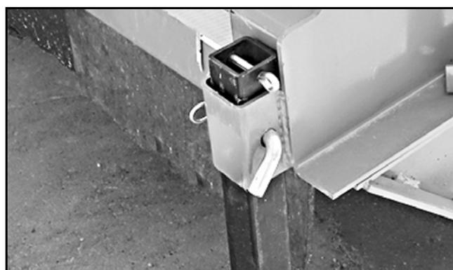
**Figura 44.** Suportes dianteiros instalados
