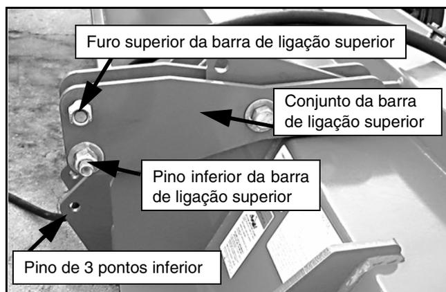
**Figura 3.** Acessório do engate de 3 pontos
