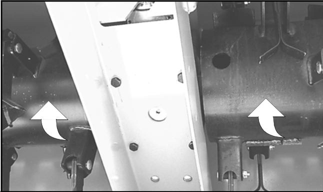
Figura 37. Sentido de rotação do rotor
