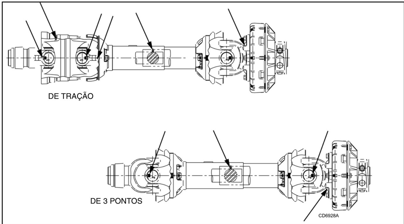
**Figura 22.** Pontos da lubrificação da transmissão da TDP
