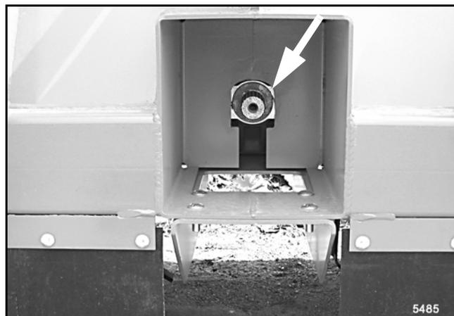
**Figura 43.** Eixo da entrada da caixa de engrenagens
