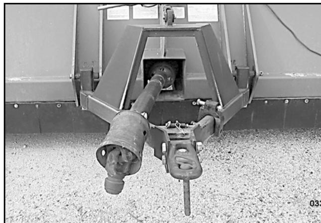
**Figura 45.** Engate de tração instalado
