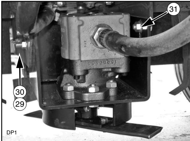
Figura 54. Conjunto do motor instalado
