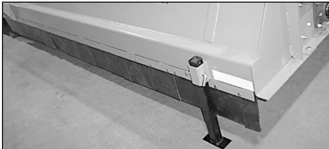
Figura 35. Cortina de proteção de borracha dianteira
