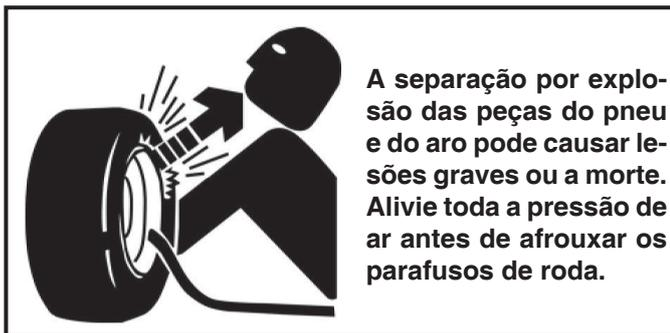
Não tente montar um pneu, a menos que você tenha o equipamento adequado e experiência para realizar o trabalho.
