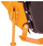
Suporte de estacionamento tubular integrado ao equipamento garante fácil armazenamento e conexão.
